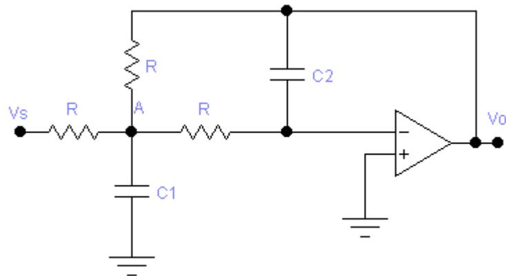
essendo il guadagno in banda passante unitario  $|A_0|=1$ , si sceglie la soluzione a resistenze uguali  $R_1 = R_2 = R_3 = R$
