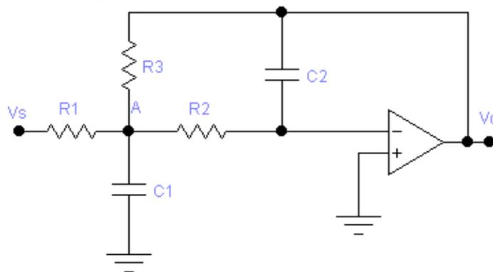
ponendo nell'eq. [2],  $Y_1 = \frac{1}{R_1}$ ,  $Y_2 = sC_1$ ,  $Y_3 = \frac{1}{R_2}$ ,  $Y_4 = \frac{1}{R_3}$ ,  $Y_5 = sC_2$  si perviene alla seguente f.d.t
