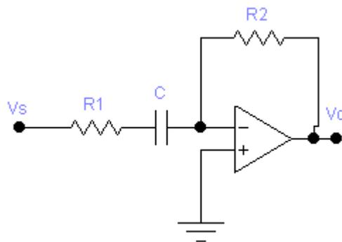
ottenuto ponendo:  $Y_1 = \frac{1}{R_1}$ ,  $Y_2 = 0$ ,  $Y_3 = sC$ ,  $Y_4 = 0$ ,  $Y_5 = \frac{1}{R_2}$  ottenendo il derivatore reale.
